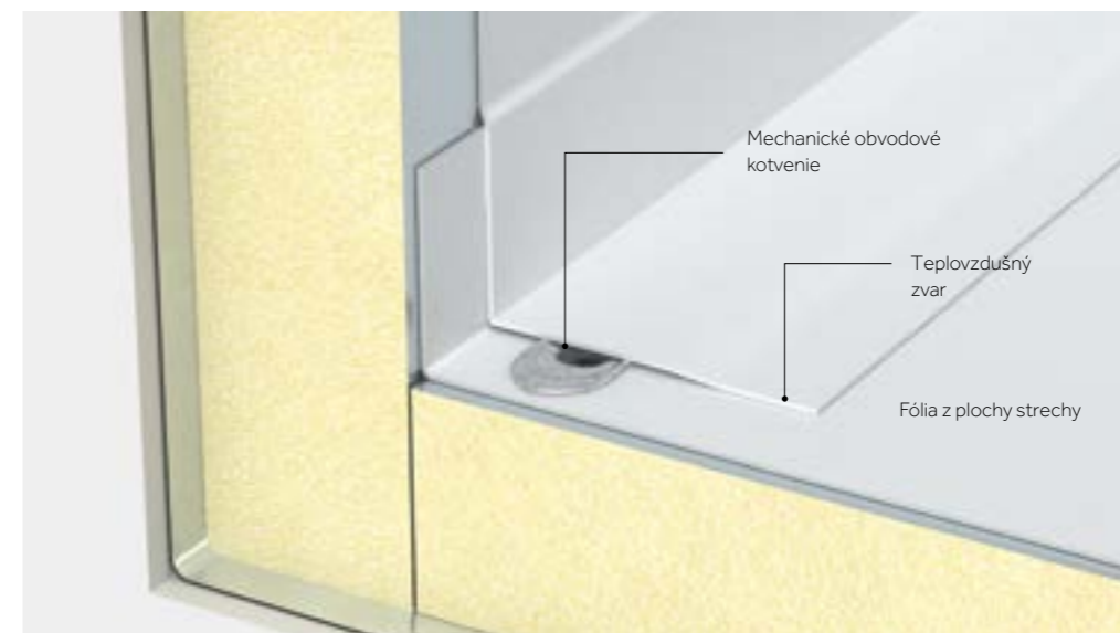
Obr. 3. Obvodové kotvenie s použitím mechanického kotvenia.
